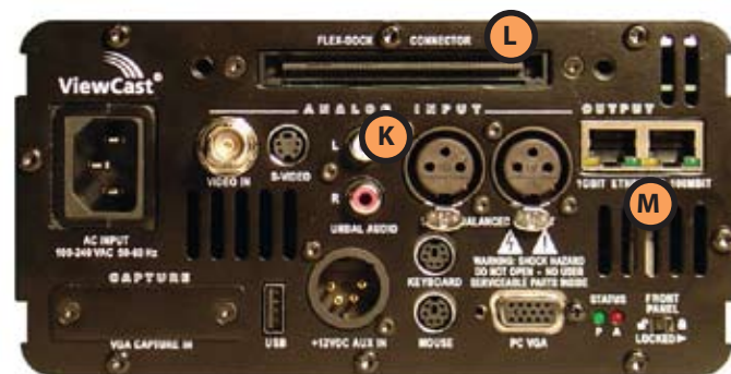
The GoStream rear panel contains multiple AV input options.
